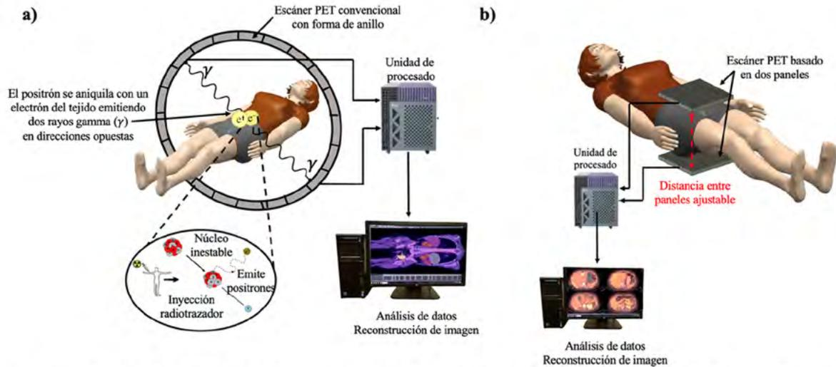
**Figura 1.** (a) Principio de formación de imágenes empleando en PET convencional con geometría de anillo; (b) Geometría del escáner PET propuesto basado en dos paneles para optimizar las imágenes obtenidas.
