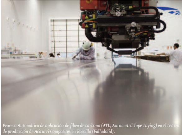
Proceso Automático de aplicación de fibra de carbono (ATL, Automated Tape Laying) en el centro de producción de Aciturri Composites en Boecillo (Valladolid).
