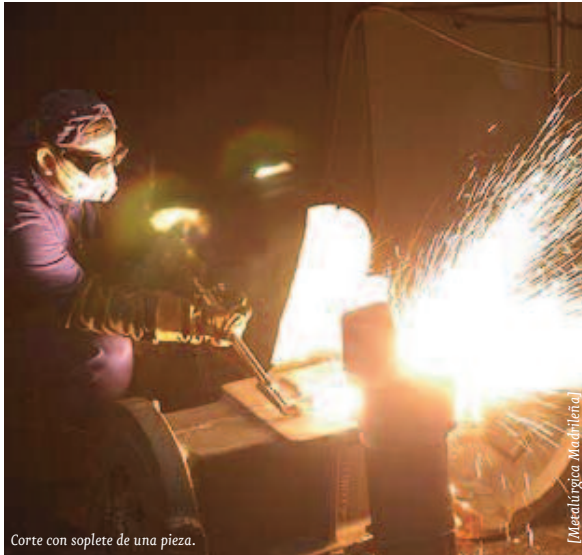
Corte con soplete de una pieza.
